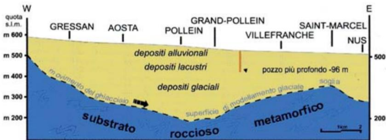
Figura 9 – Profilo del sottosuolo del fondovalle della Dora tra Gressan e Nus. I sedimenti glaciali, lacustri ed alluvionali, spessi fino a 350 m, rivestono il substrato roccioso modellato a conca dall’erazione del ghiacciaio balteo (da Bonetto & Gianotti 1998).
